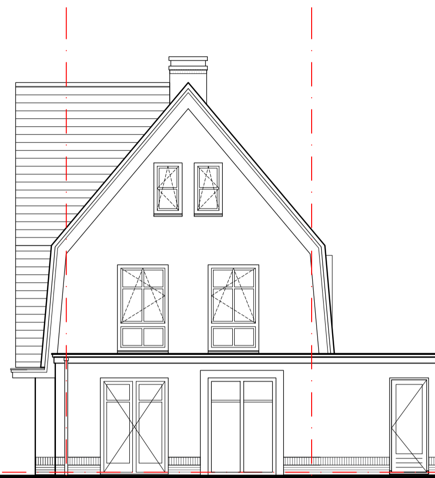
Achtergevel optie A2-03 - uitbouw achtergevel 1200mm optie A2-04 - uitbouw achtergevel 2400mm
