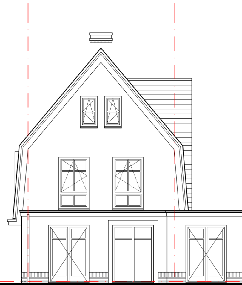
Achtergevel optie A1-B-05 - uitbouw achtergevel 2400mm met tuinkamer
