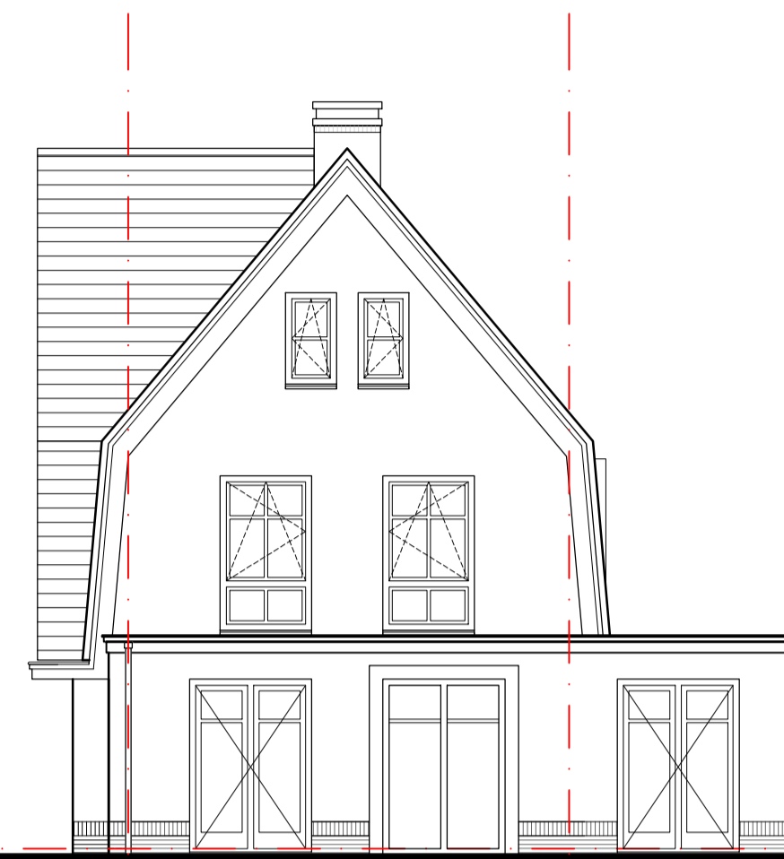
Achtergevel optie A2-05 - uitbouw achtergevel 2400mm met tuinkamer
