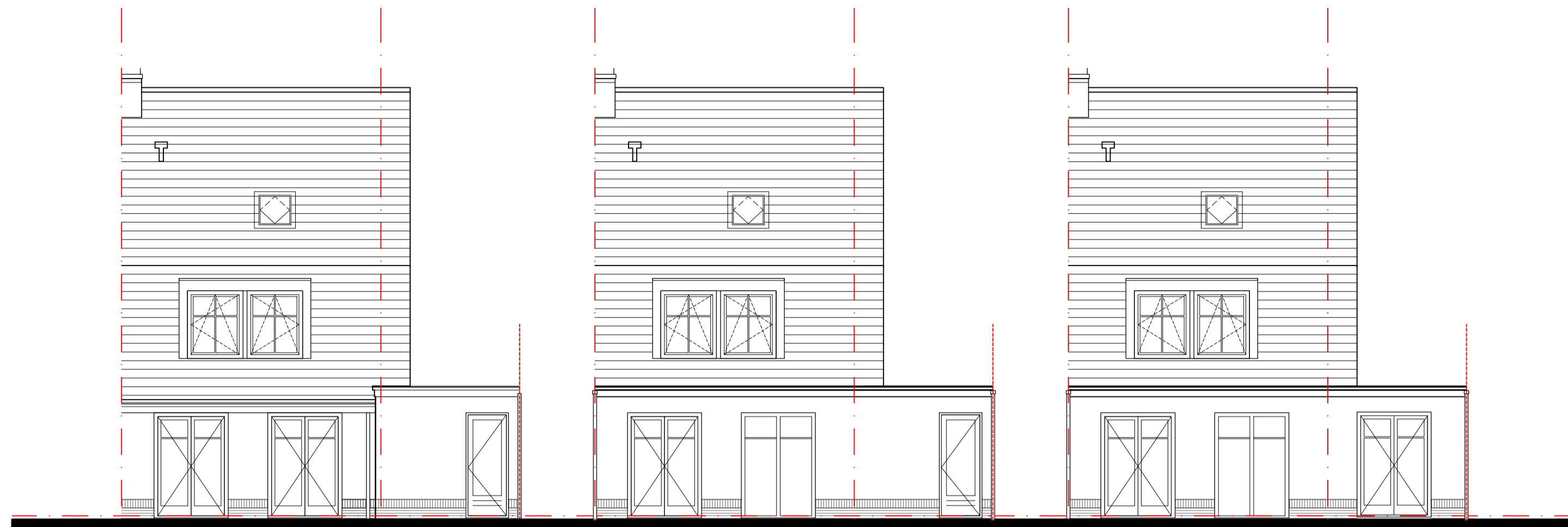
Achtergevel optie B1-01 - extra dubbele deuren achtergevel
